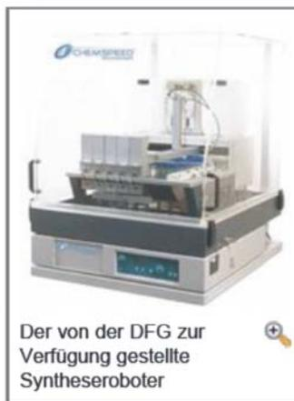
Der von der DFG zur Verfügung gestellte Syntheseroboter
